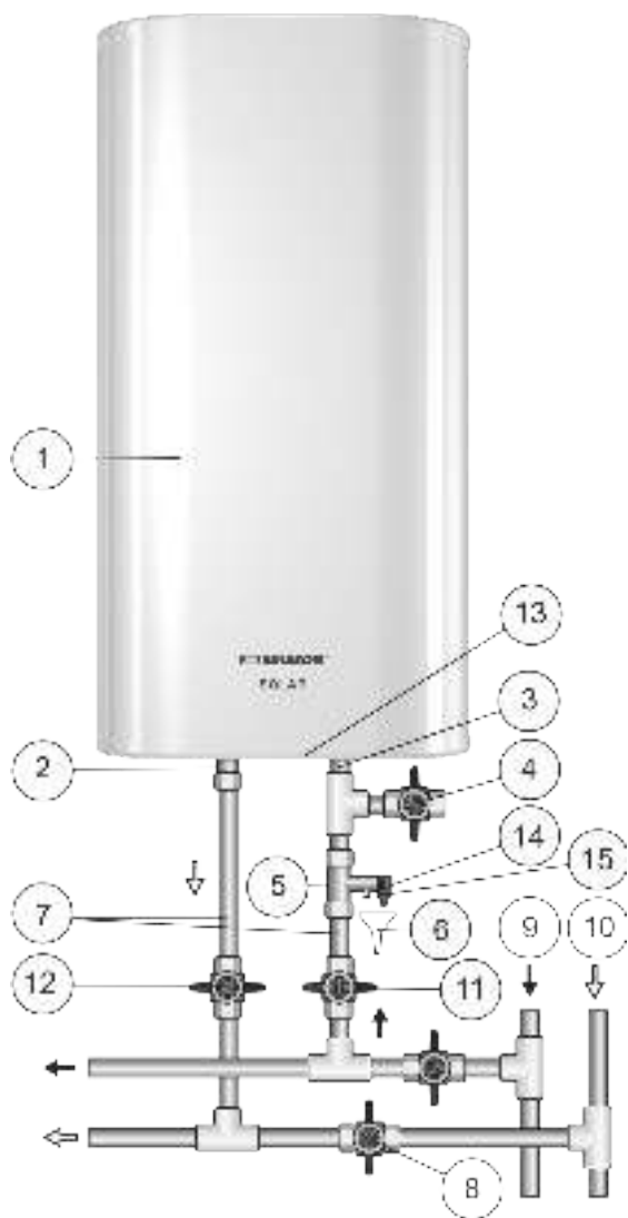
Рисунок 1. Схема подключения ЭВН к водопроводу сверху и снизу
